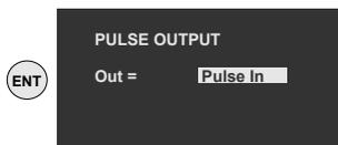
Проверьте, совпадает ли импульсный выход с импульсным входом.
